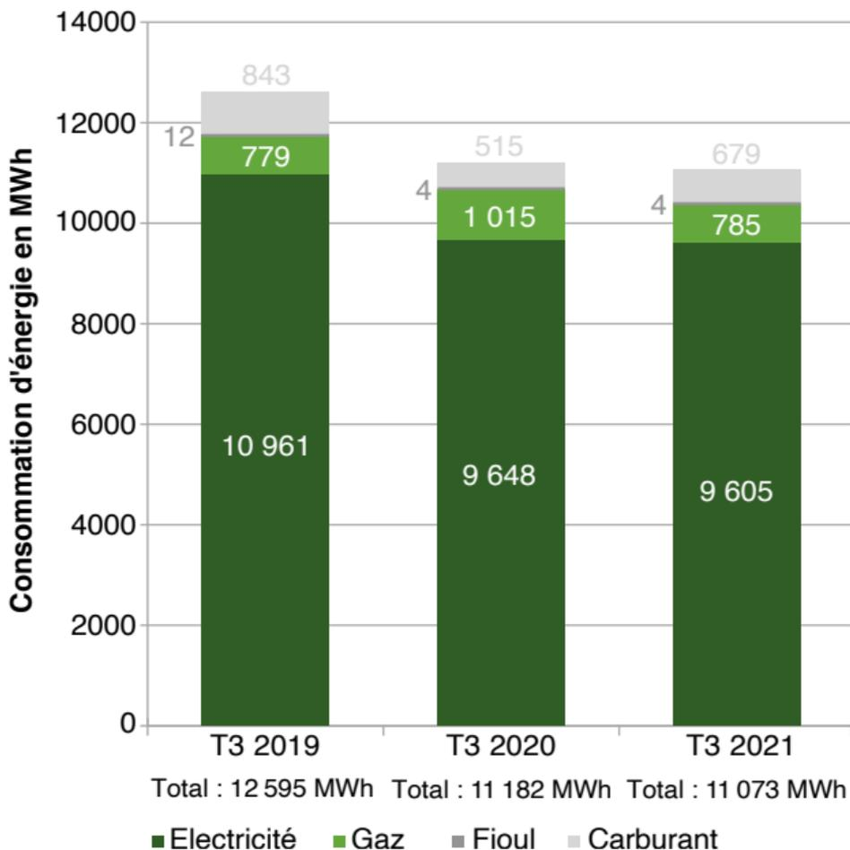
La consommation énergétique de la plate-forme regroupe l'utilisation de quatre types d'énergies différentes : l'électricité, le gaz, le fioul et le carburant. Sont représentées au travers du graphique suivant les consommations des énergies fournies et distribuées par la Direction de l'Aéroport. L'avitaillement est exclu.
